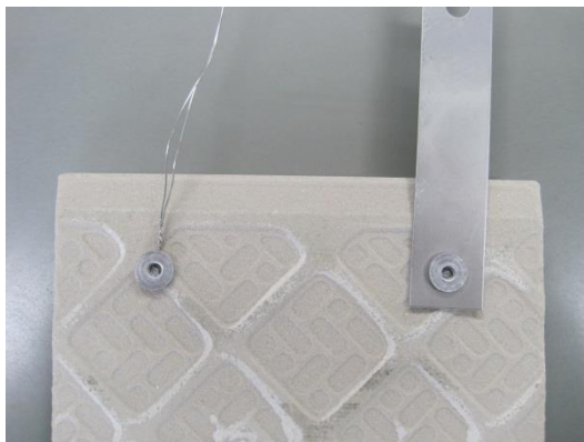
写真左:ステンレス線、写真右:金具でのリベット加工常態
